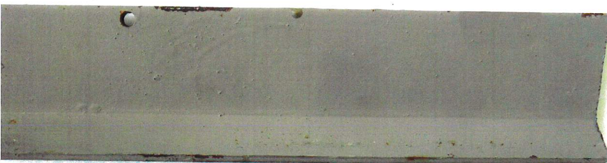
Échantillon de la frise sur Vitrage existante (acier peint gris de 6 mm d'épaisseur)
