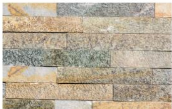
Socle en maçonnerie : Granit américain agencé à l'existant Module 90mm x 900mm, face éclatée, appareillage en panneresse
